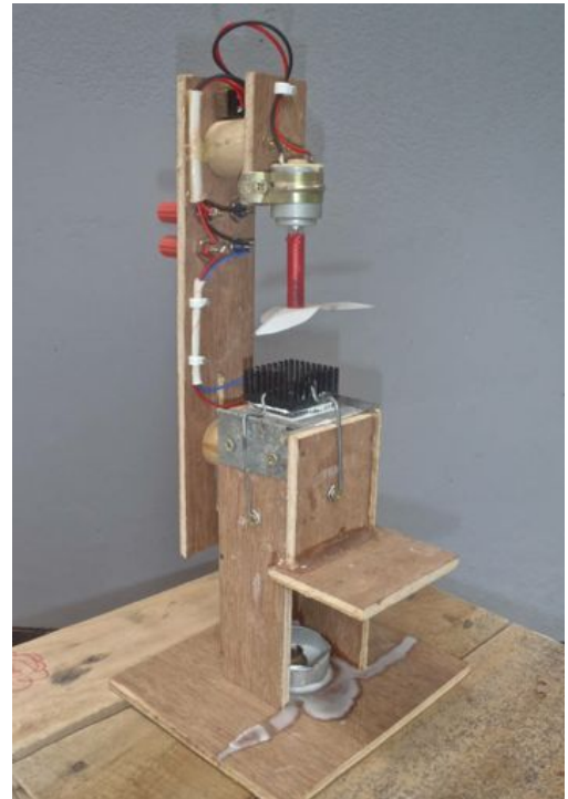
Ein Peltier-Element erzeugt bei Erhitzen mit einer Kerzenflamme einen Gleichstrom.
