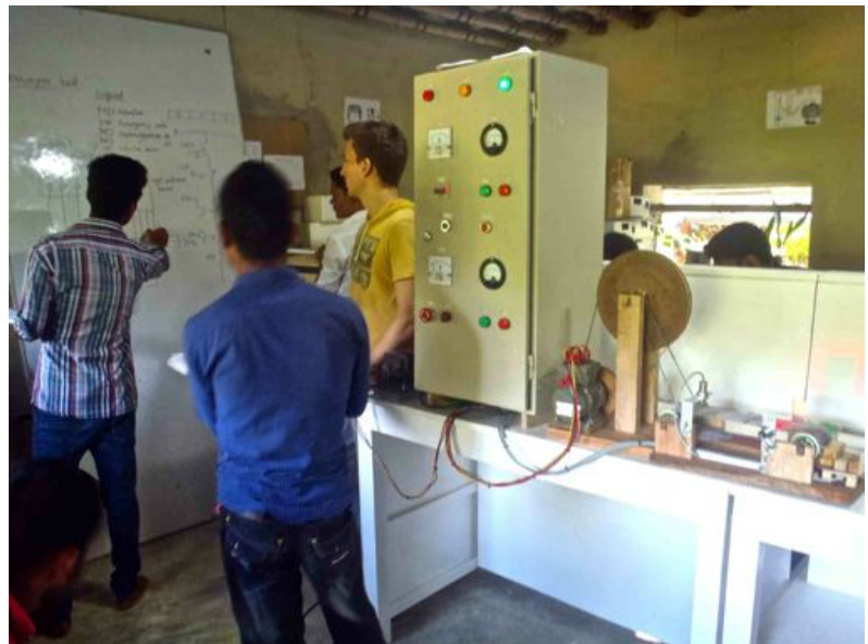
Der grosse Steuerkasten von David kommt immer wieder zu Ehren. Rechts das Förderband mit einem Stückzähler.
