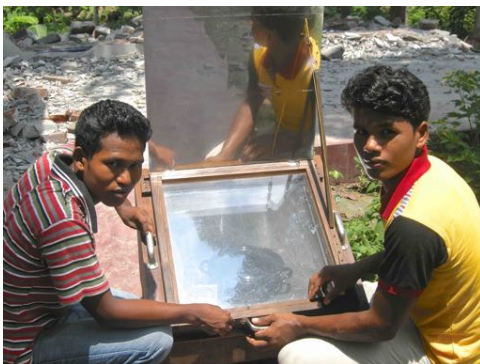
Kochkiste um Reis zu kochen. Es können Temperaturen bis 150°C erreicht werden.
