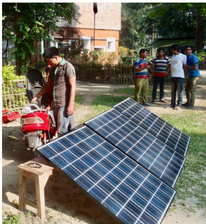
Fotovoltaik, laden eines Elektromovas
